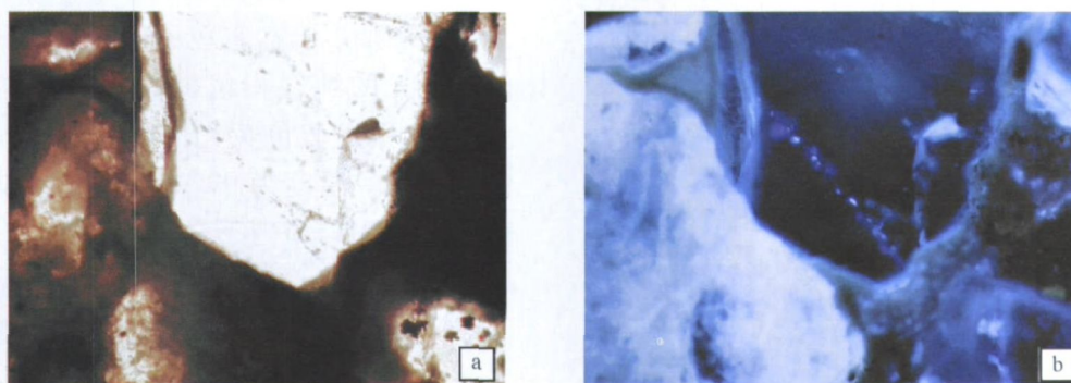
图 2 榆 32 井石英颗粒内裂纹中见发蓝白色荧光的油包裹体
